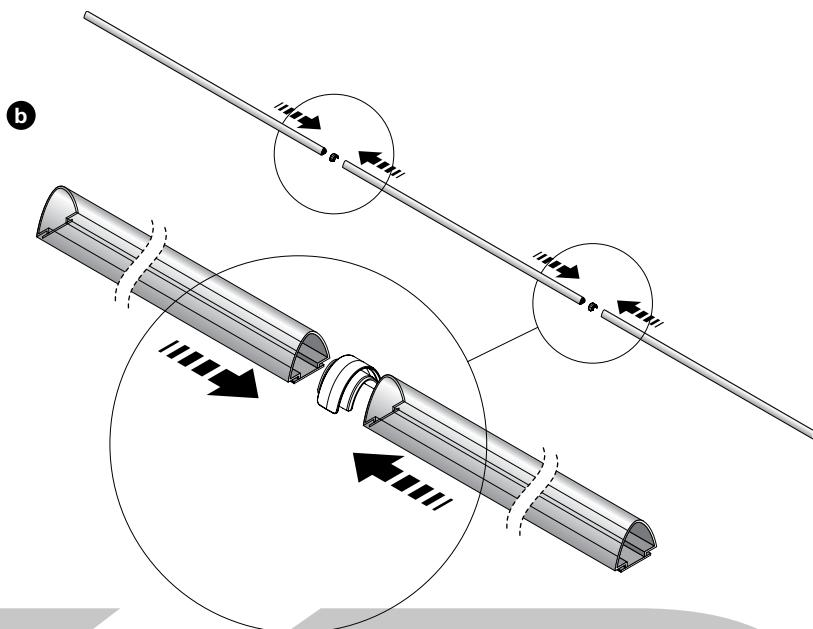
**c** - Vložte spojku protinárazovej gumeny a kroky opakujte s ďalšími kusmi. Poznámka - protinárazová guma môže vytŕčať na konci hliníkového profilu približne o 1 cm.
