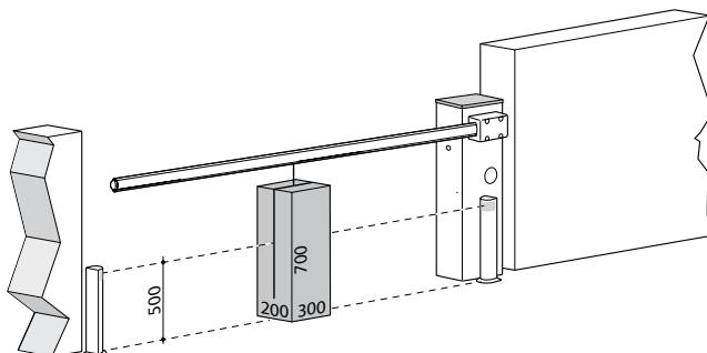
V prípade skúšky dvoch párov fotobuniek sa skúška musí vykonať najprv jednotlivo pre každý pár fotobuniek s použitím jedného skúšobného telesa, a potom sa skúška zopakuje s dvomi skúšobnými telesami. Každé teleso sa umiestní povedľa stredu ramena do vzdialenosťi 15 cm, a potom sa posúvajú po celej dĺžke ramena.
