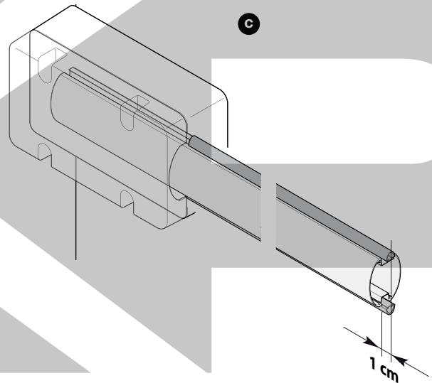
**d** - Vložte záslepku ramena a zablokujte ju pomocou 2 dodaných skrutiek.
