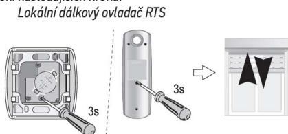
[5]. Stisknutím tlačítka „Test“ zkонтrolujte, zda спáровání úspěšně proběhlo.
