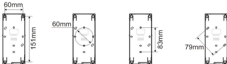
1. Ve spodní části zařízení jsou otvory pro připevnění na zeď podle výše uvedených instrukcí.
