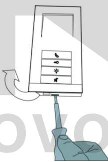
Zatáhněte za svorku na spodní části zařízení a poté otevřete kryt panelu.
