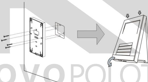
1. Připevněte spodek zařízení ke stávající nástěnné skříně.
