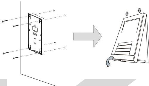
1. Připevněte spodní část zařízení ke zdi.
